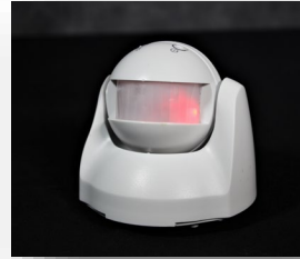
Sensor infrarrojo pasivo (PIR, en inglés) Detecta el movimiento
