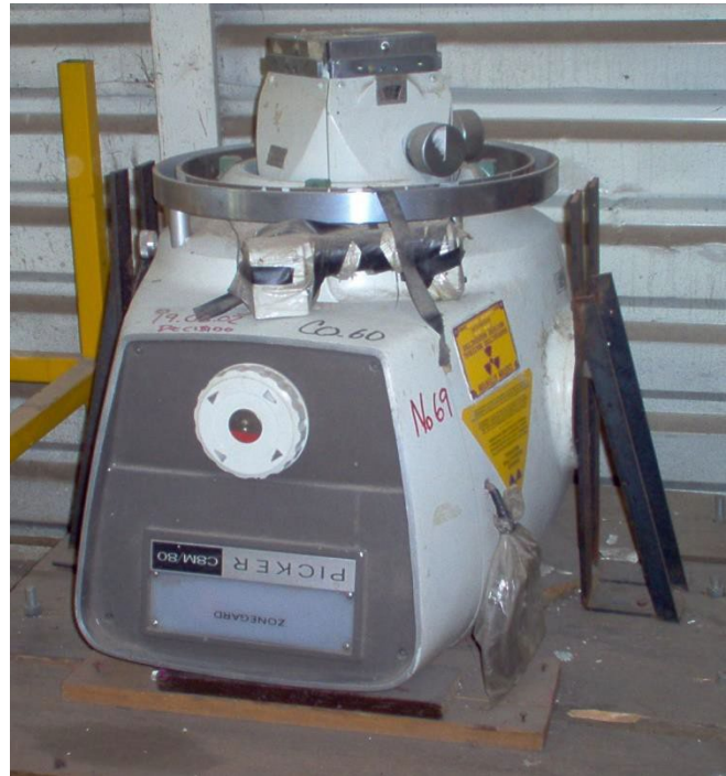
Cabezal de teleterapia con ^{60}\text{Co} . Actividad= 3.70 \times 10^{14} Bq.
