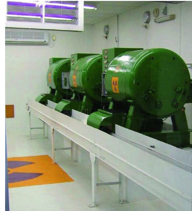
Irradiadores autoblandados de ^{137}\text{Cs} , con actividad total de 2.08 \times 10^{15} Bq (programa del gusano barrenador del ganado)
